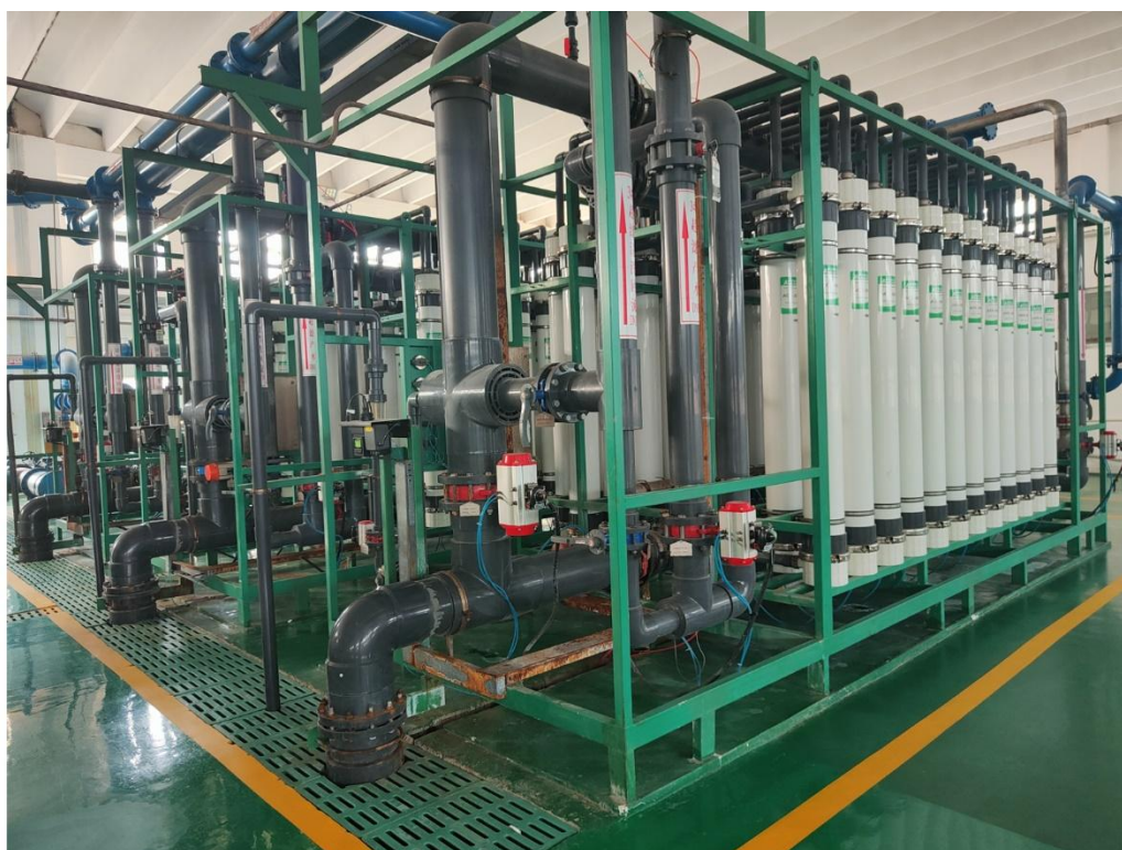
阳谷森泉水厂公司日处理 2 万吨再生水回用设备
